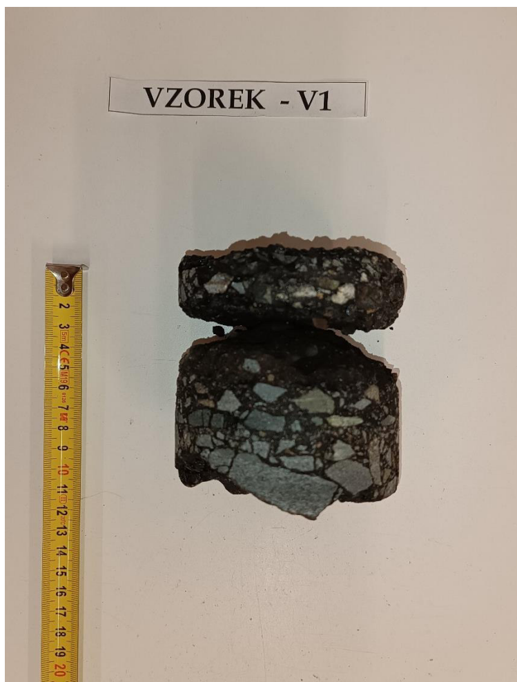
Obr. 2 - Jádru vývrtu Vzorek – V1 (laboratoř).
