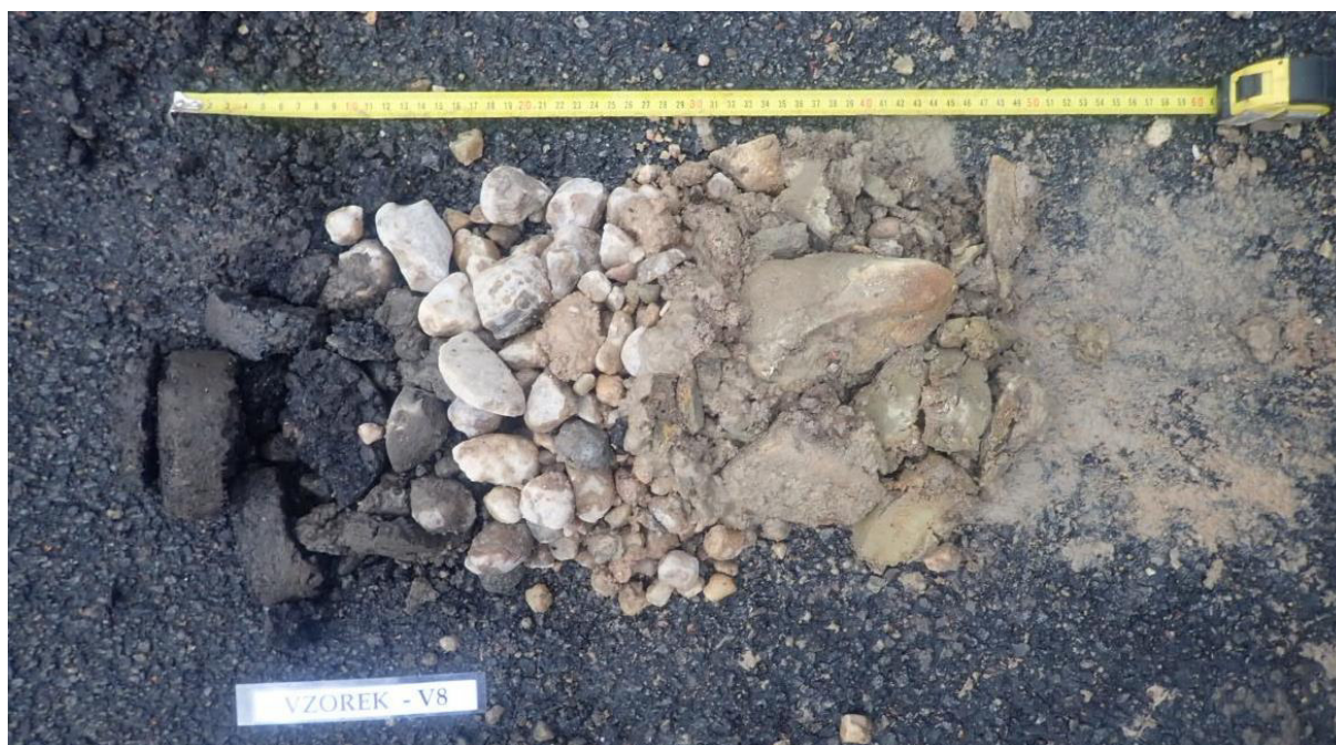
Obr. 15 - Jádru vývrtu Vzorek – V8 (in situ).
