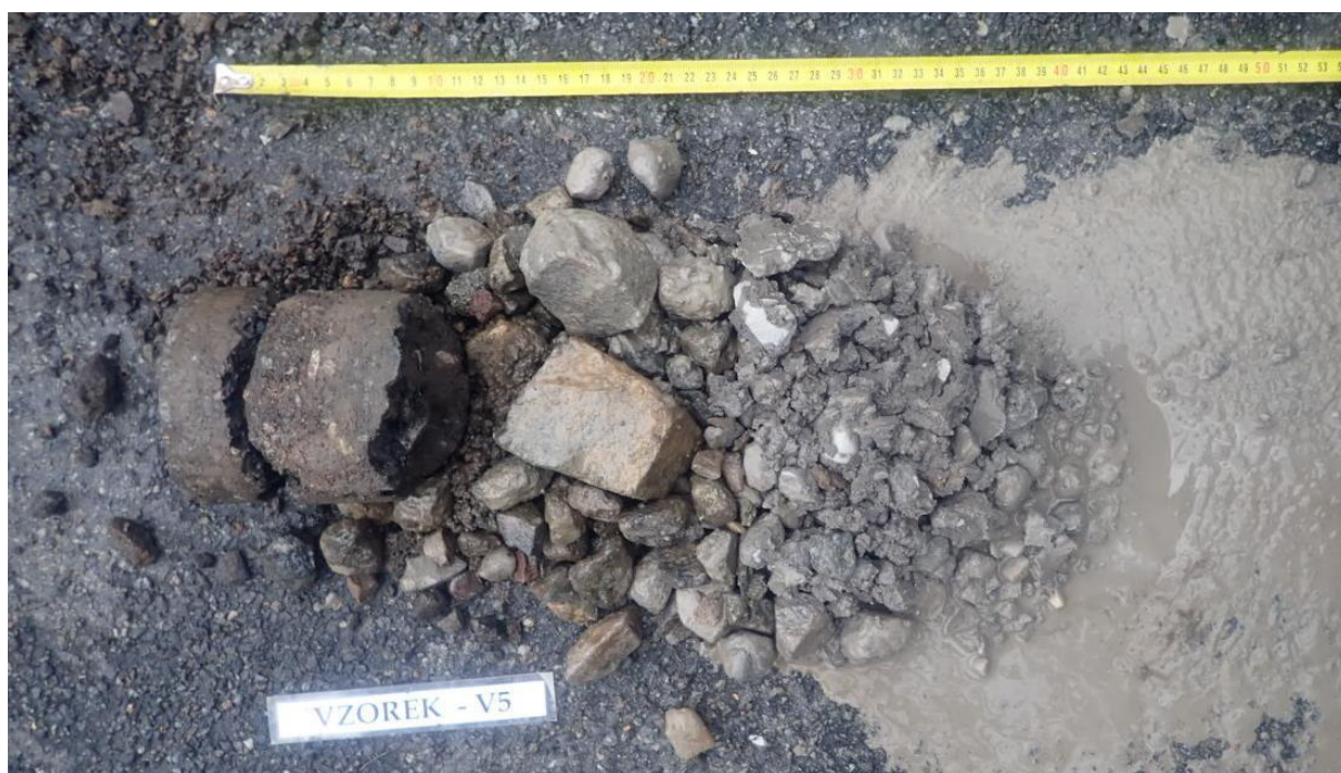
Obr. 9 - Jádro vývrtu Vzorek – V5 (in situ).
