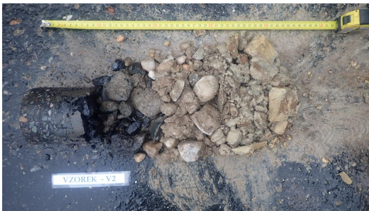
Obr. 3 - Jádro vývrtu Vzorek – V2 (in situ).
