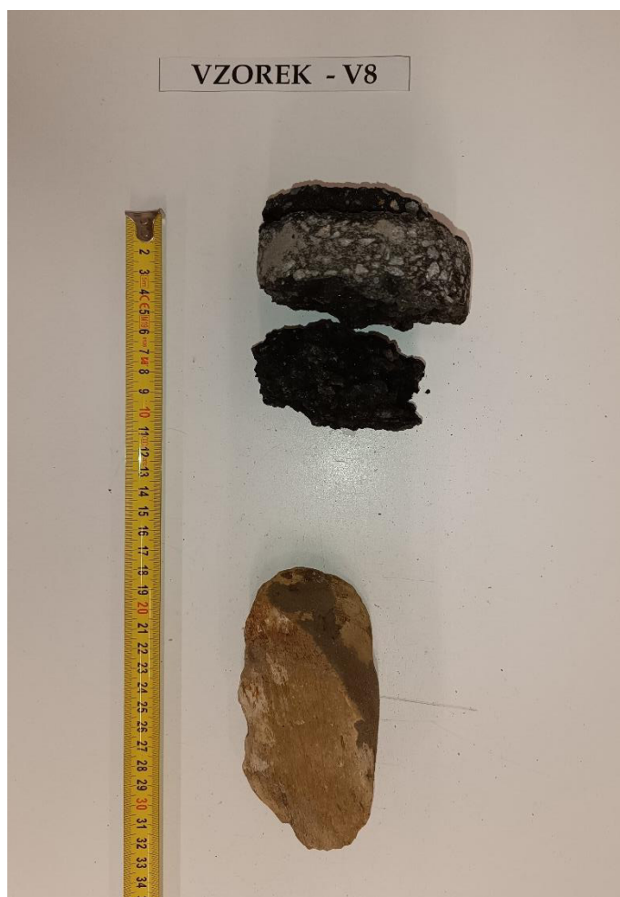
Obr. 16 - Jádro vývrtu Vzorek – V8 (laboratoř).
