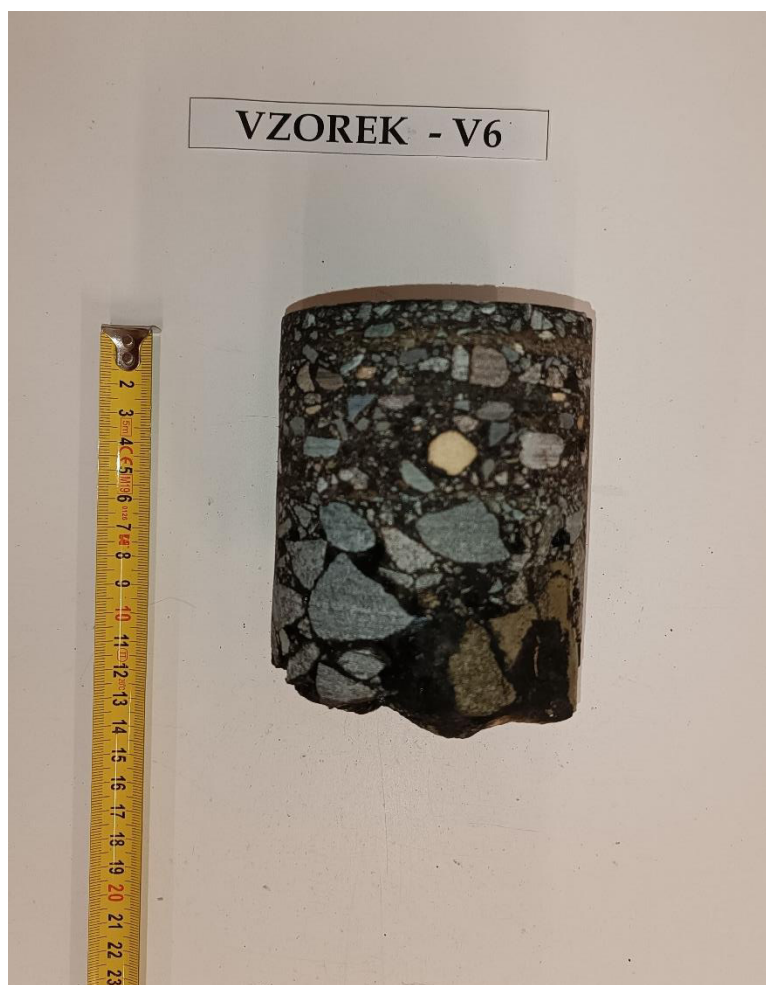
Obr. 12 - Jádro vývrtu Vzorek – V6 (laboratoř).
