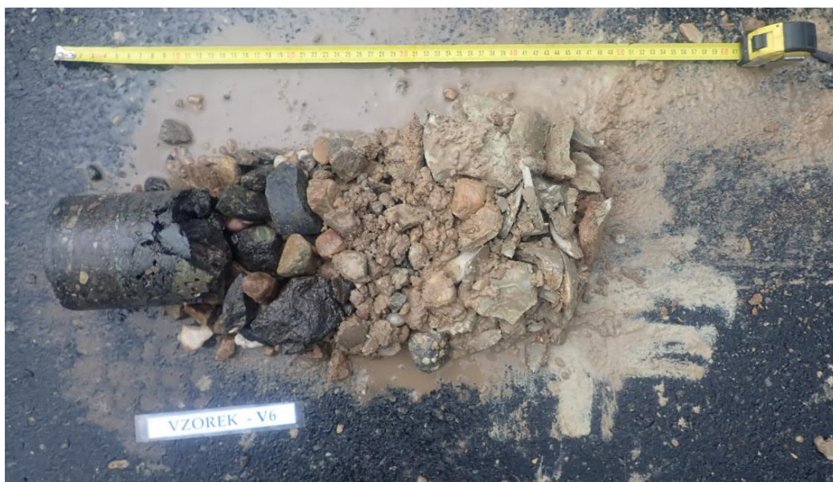
Obr. 11 - Jádru vývrtu Vzorek – V6 (in situ).
