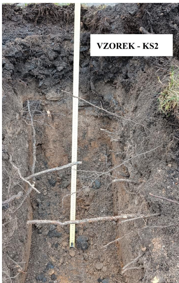
Obr. 18 – Kopaná sonda Vzorek – KS2 (in situ).
