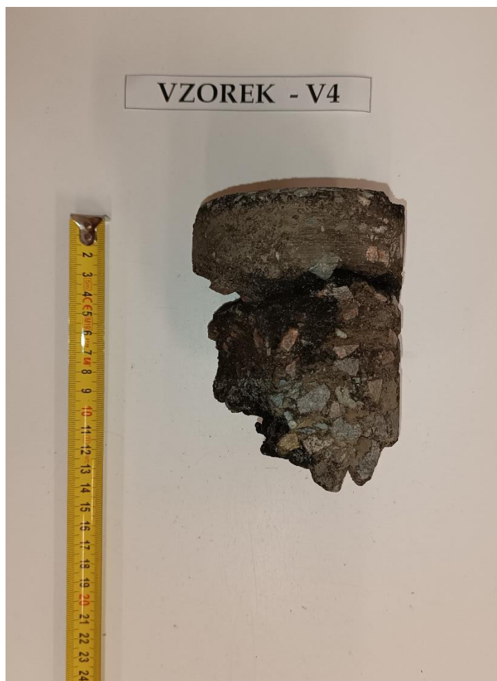
Obr. 8 - Jádru vývrtu Vzorek – V4 (laboratoř).
