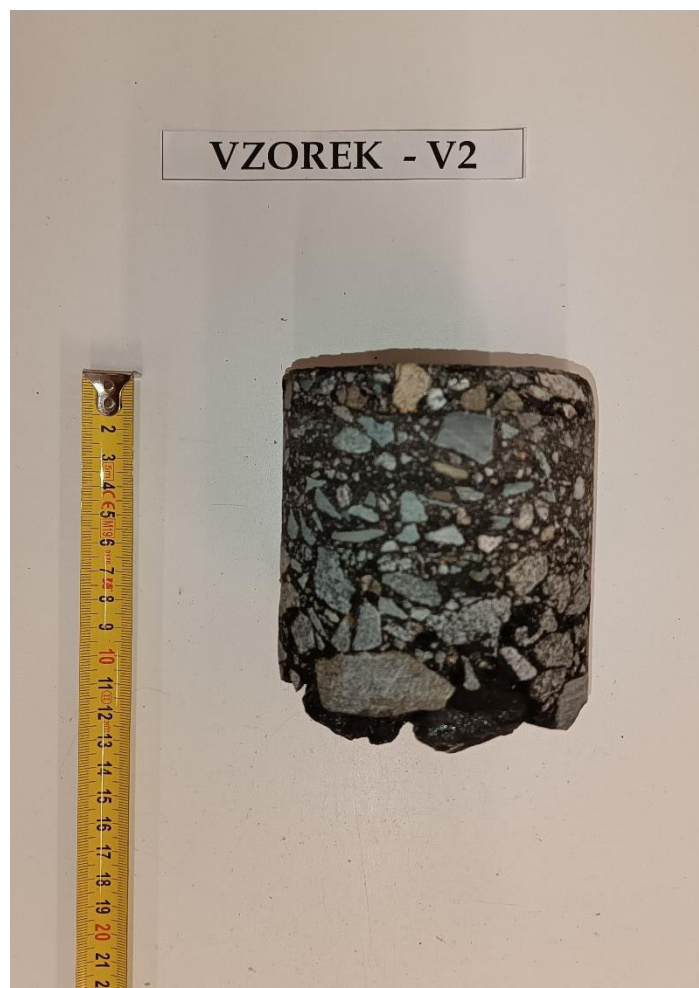
Obr. 4 - Jádru vývrtu Vzorek – V2 (laboratoř).
