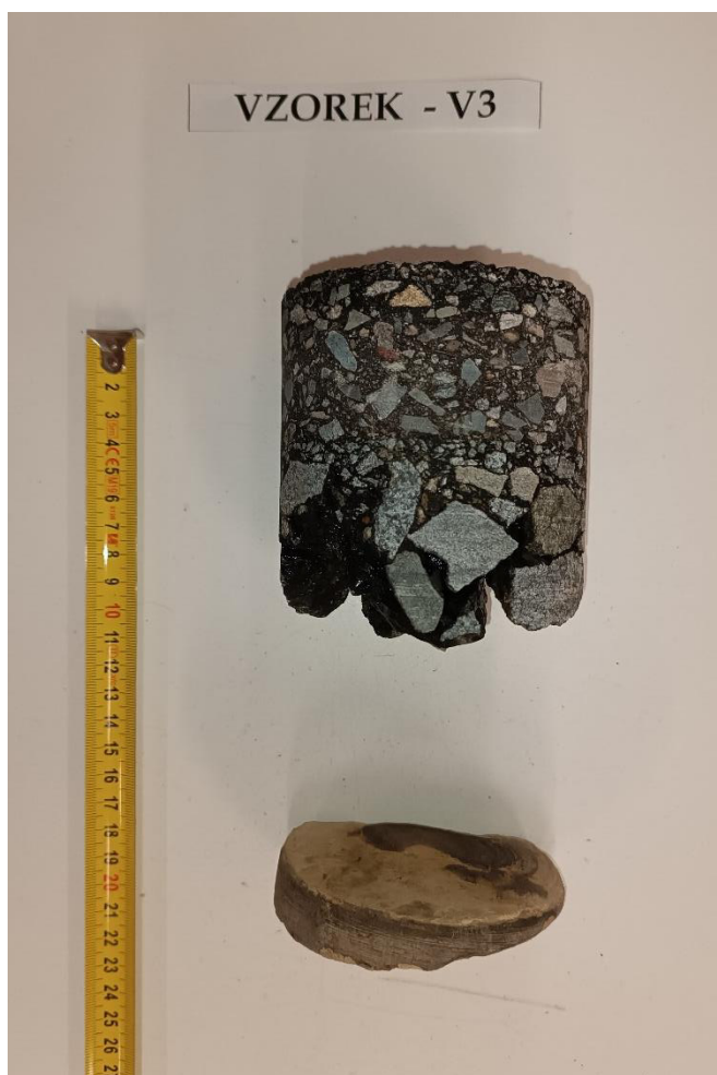
Obr. 6 - Jádru vývrtu Vzorek – V3 (laboratoř).
