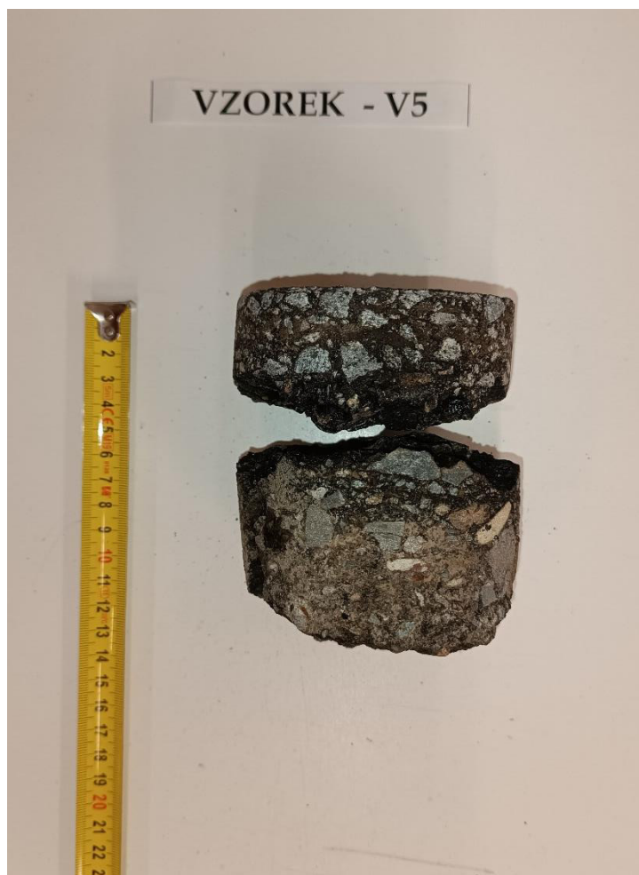
Obr. 10 - Jádru vývrtu Vzorek – V5 (laboratoř).
