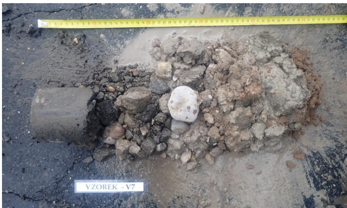
Obr. 13 - Jádro vývrtu Vzorek – V7 (in situ).
